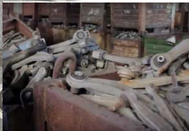
Querlenker vor der Aufbereitung, li. nach der Instandsetzung © Katok
